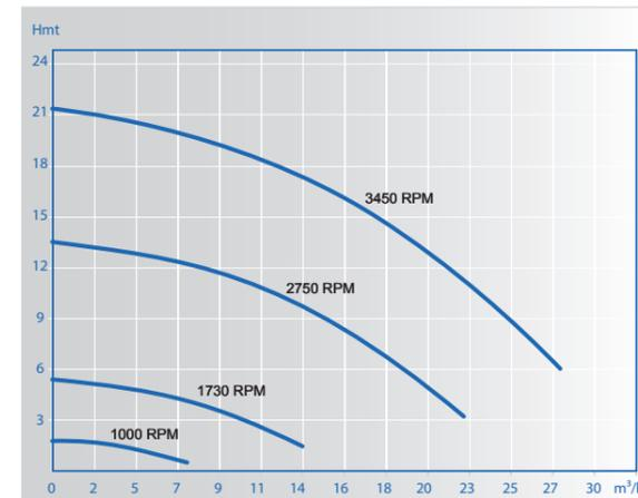
Die einzelnen Kurven zeigen die Leistung bei unterschiedlichen Drehzahlen (RPM = U/min).
